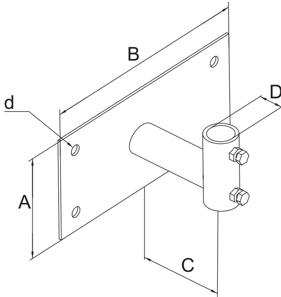
Предназначен для крепления мачты молниеприемника высотой до 4 м на вертикальных конструкциях здания.
